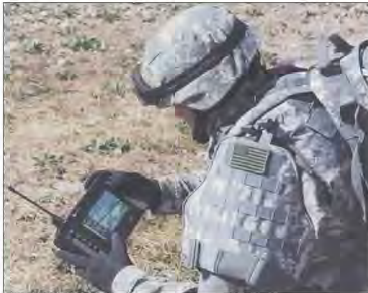
Американский военнослужащий с помощью аппаратуры «Ровер-5» осуществляет прием видеoinформации с разведывательного БЛА в режиме реального времени
