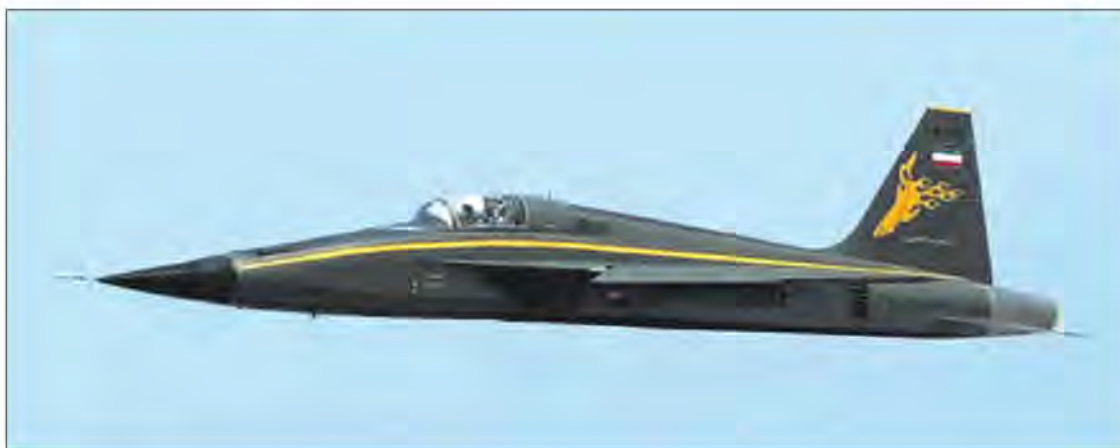
Истребитель «Азарахи» ВВС Ирана разработан национальной компанией IAMI на базе американского самолета F-5E/F «Тайгер-2»
