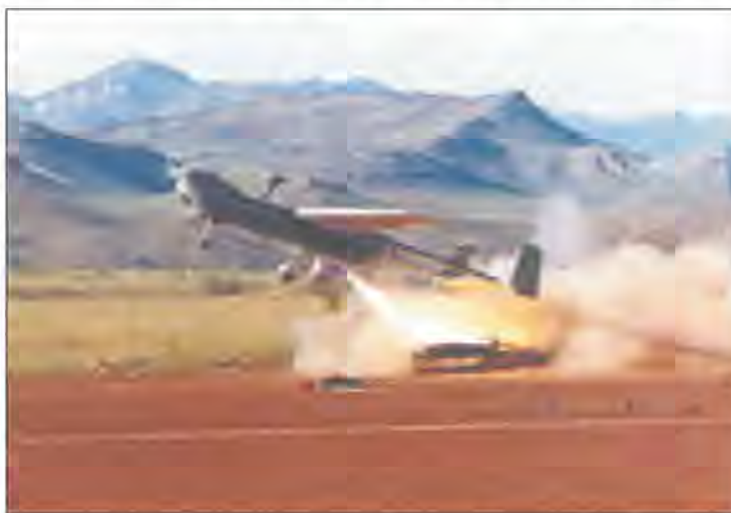
Запуск БЛА «Хантер» с помощью твердотопливных стартовых ускорителей
